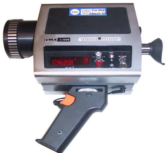
Obr. 5-18 Fotografie digitálního jasoměru typu L 1009 německé firmy Lichtmesstechnik Berlin
