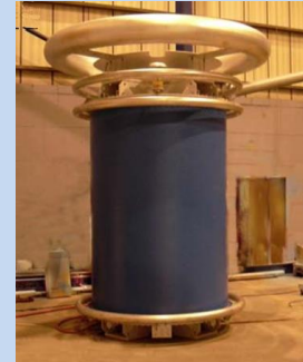
Zkušební transformátor s izolační válcovou nádobou
