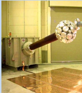
Zkušební transformátor s kovovou nádobou
