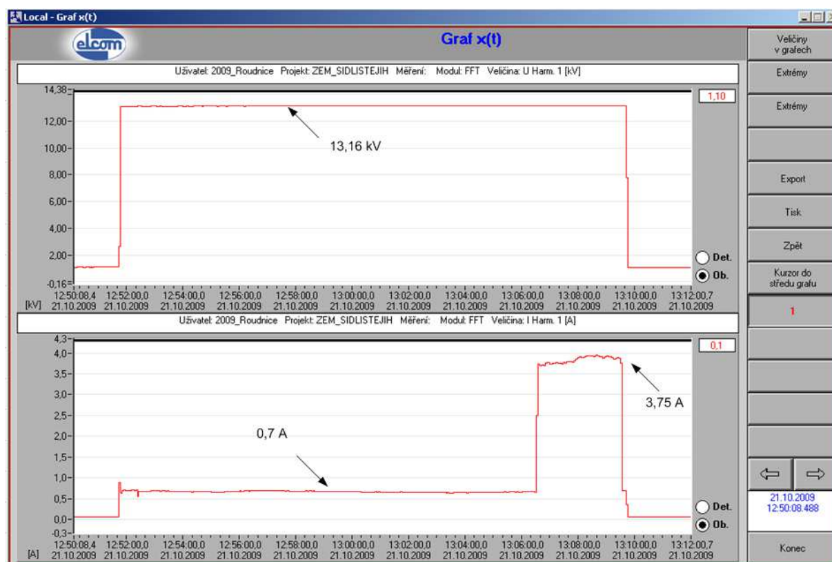
Obrázek 2: Přizemnění postižené fáze při „kovovém“ zemním spojení
