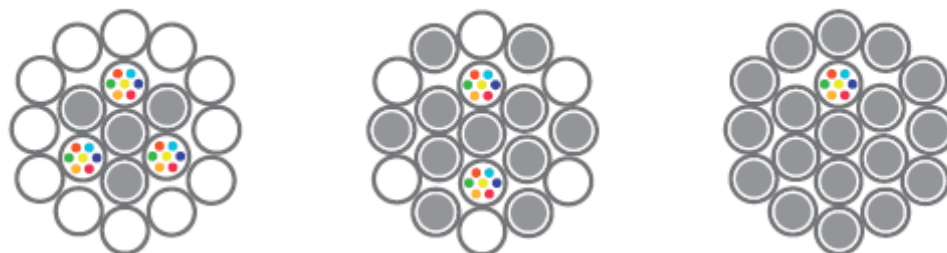
Konstrukce OPGW se středovou trubičkou
