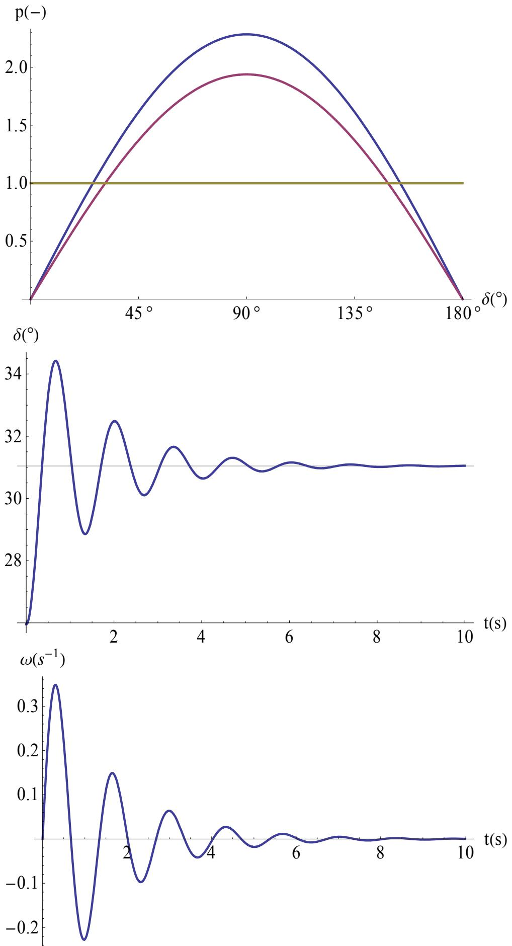
$$P_{\text{mech}} = 1; \quad P_{\text{max1}} = 2,285; \quad P_{\text{max2}} = 0,55 \cdot 1,939 = 1,067; \quad \text{damping } B = 0,0003$$
