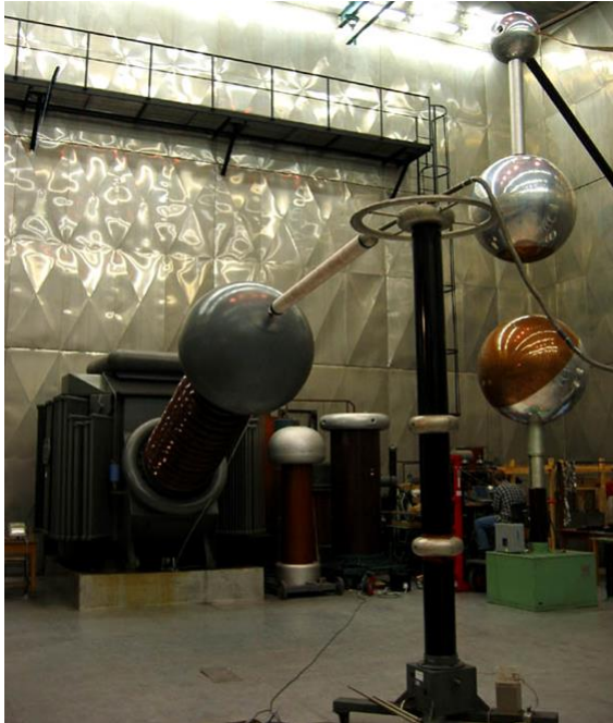
Zkušební transformátor s uzemněnou nádobou a průchodkou
