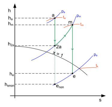
$h_a = 3\ 450\ kJ.kg^{-1}$ ;  $h_{2a} = 2\ 920\ kJ.kg^{-1}$ ;  $h_m = 3\ 370\ kJ.kg^{-1}$ ;  $h_e = 2\ 275\ kJ.kg^{-1}$ ;  $h_{enon} = 2\ 050\ kJ.kg^{-1}$
